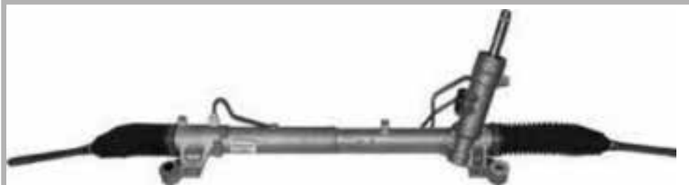
Lungh.1290 - Senza sensore - Fabr. TRW - con Silentblock
