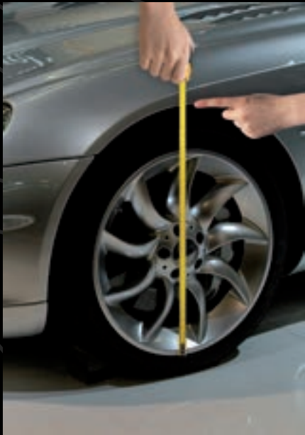
Corretto sistema di misurazione dell'assetto, PRIMA e DOPO l'intervento / Correct system of measuring the suspension levelling, BEFORE and AFTER
