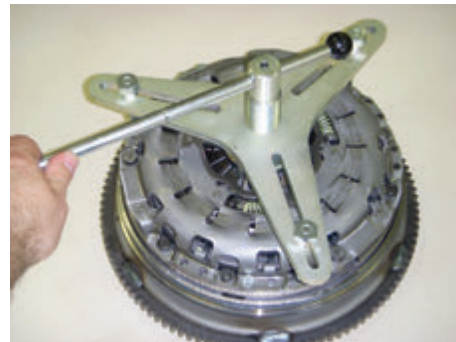
12. Avvitare la barra filettata alla leva fino a quando viene azionato la molla a disco. Attenzione: Ruotare solo fino a quando il coperchio della piastra spingidisco si appoggia al disco volante.
