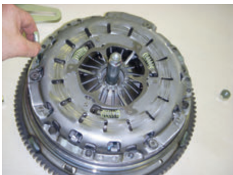
16. Rimuovere i tiranti filettati
