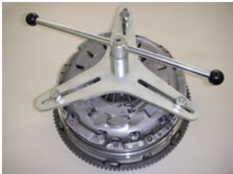
10. Guidare il dispositivo di serraggio SAC sopra i tiranti filettati.
