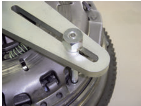
11. Avvitare manualmente i dadi esagonali finché fanno presa con i tiranti filettati (montaggio parallelo alla serie degli utensili per frizioni SAC). Attenzione: L'asta filettata deve essere completamente svitata.
