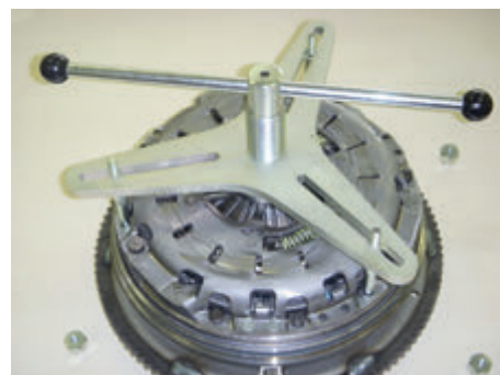
15. Svitare i dadi esagonali – togliere l'elemento di centraggio.
