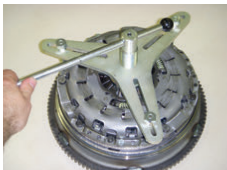
14. Estrarre completamente la barra filettata – la molla a disco si espande.
