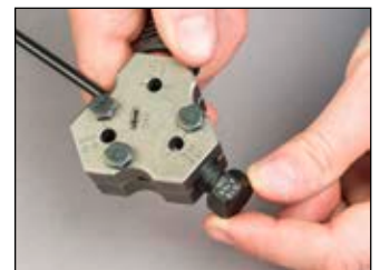
DIN flaring process
