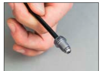
DIN flaring process
